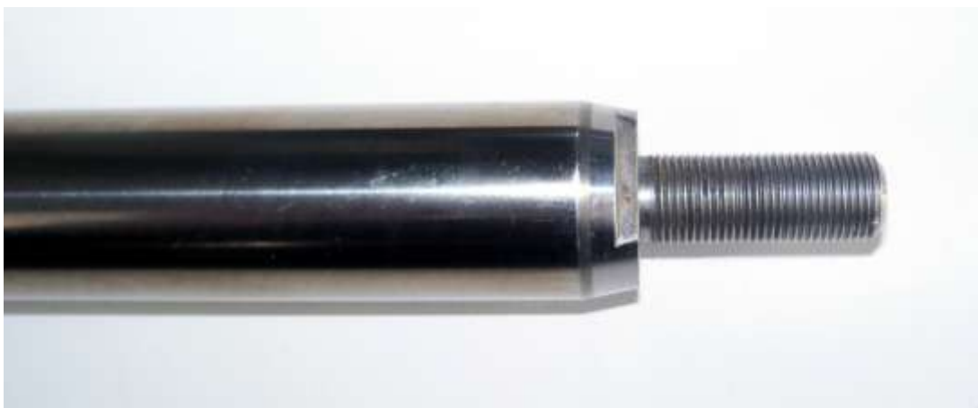
Рис. 30. Общий вид штока ПГГ (а), б – поршневая часть штока с бронзированием и резиновыми уплотнениями круглого сечения (одно кольцо уплотнения накрыто фторопластовой манжетой), на рис. общий вид герметизирующей заглушки, для заправочного клапана штока, с шариковым замком, в канавке перед поршневой частью видно отверстие – внутренние полости ПГГ заполнялись гидравлической жидкостью методом вакуумной заправки, в – крепление заправочного клапана штока гайкой, г – шпилька для установки серьги со сферическим подшипником крепления на выдвижном сопловом насадке.
