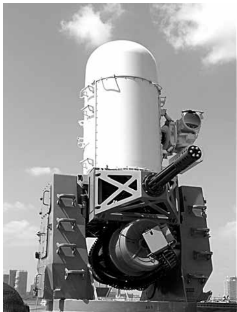
Рис. 9. Комплекс Phalanx CIWS с 20-мм шестиствольной автоматической пушкой
