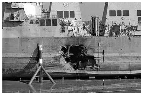
Рис. 1. Пробоина в борту эсминца «Cole»
