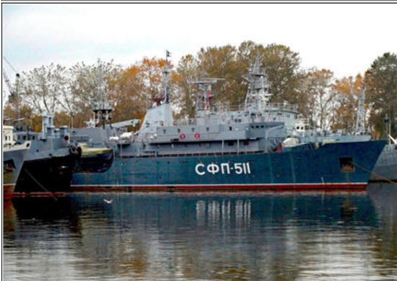
Суда контроля физических полей проекта 1806, 18061, 18061БД, 18061К шифр «Звук» (СФП-511, кфпс «Академик Семенихин»), предназначены для измерения акустического, электромагнитного, электрического, магнитного полей надводных кораблей и подводных лодок.
