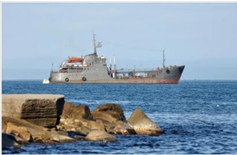
предназначены для снабжения кораблей на портовых рейдах или в походах мазутом, дизельным топливом, машинным маслом или водой.
