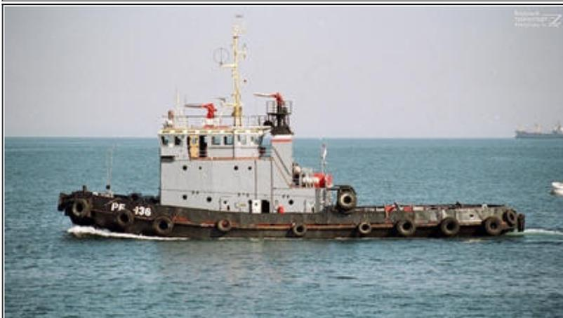
Рейдовый буксир проекта 192 («РБ-167») предназначен для буксировки и кантовке самоходных и несамоходных судов в портах и на открытых рейдах. Судно может быть использовано для буксировки судов в пределах прибрежной зоны установленного района. Так же возможно использование данного типа буксиров в спасательных операциях.
