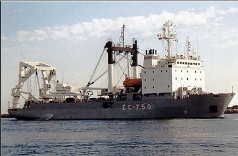
Килаторные суда проекта 141, 141С (КИЛ 140, КИЛ-158, КИЛ-168, КИЛ-498, КИЛ 926, КИЛ-927, СС-750, СС «Александр Пушкин») - вспомогательные суда используются как спасательные суда для подводных лодок, для подводных грузовых работ: постановки мёртвых якорей, бонов, расчистки фарватеров, подъёма затонувших объектов и т. д. Предназначены также для приёма с берега, перевозки, постановки и выборки рейдового оборудования.
