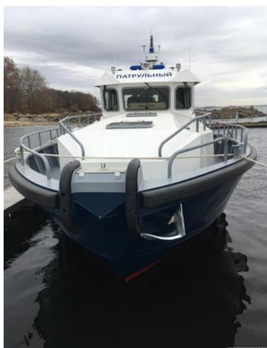
Скоростной катер проекта 12М, это катер с корпусом из алюминиевого сплава может эксплуатироваться на реках, озерах, водохранилищах, а также в прибрежных морских районах.
