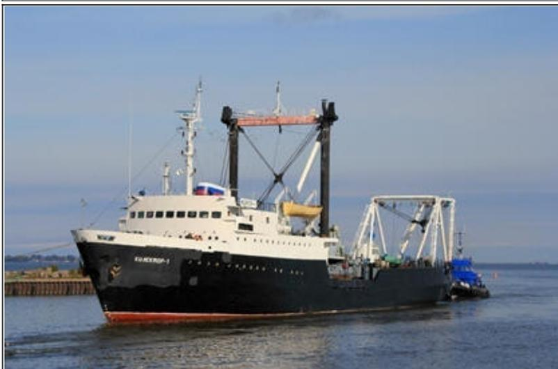
Килекторные суда (кил) проекта 419 (кил «КИЛ-1») предназначены для постановки (съемки) боно-сетевого заграждения и рейдового оборудования на глубины до 300 метров, установлики «мертвых» якорей весом до 100 тонн. Судно может быть также использовано для установки и раскрепления плавпричалов, раскладки «постели» для плавдоков и их раскрепления, обеспечения стрельб из корабельного оружия. Может нести глубоководный аппарат, предназначенный для спасения экипажей затонувших подводных лодок.
