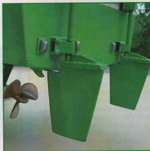
Wie beim Original ist auch am Modell die Ruderanlage fast komplett außenbords montiert. Die Anlenkung erfolgt mittels Seilzug
