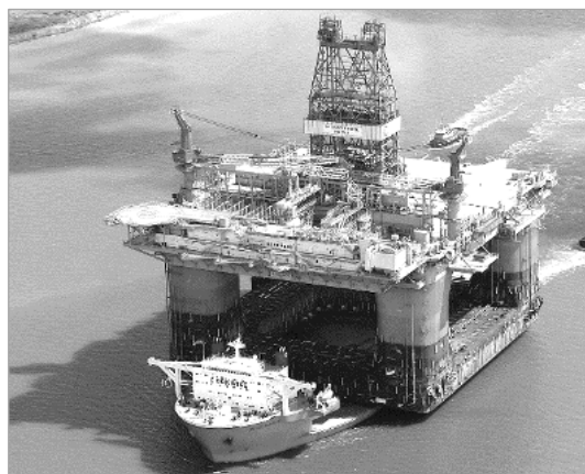
Рис. 4. Транспортировка полупогружной буровой установки на полупогружном судне
