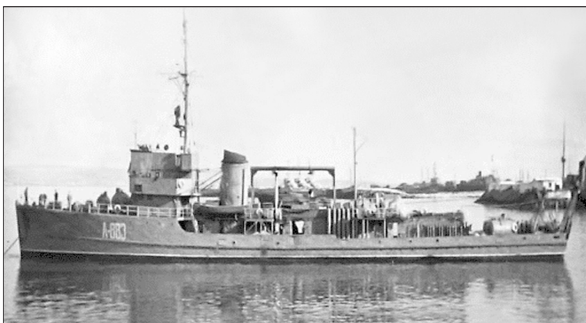
Бывший немецкий тральщик серии М, переоборудованный под спасательное судно с ГВК
