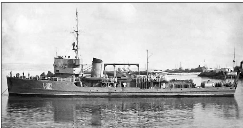
Рис. 2. Переоборудованный под спасательное судно с ГВК немецкий тральщик серии «М»
