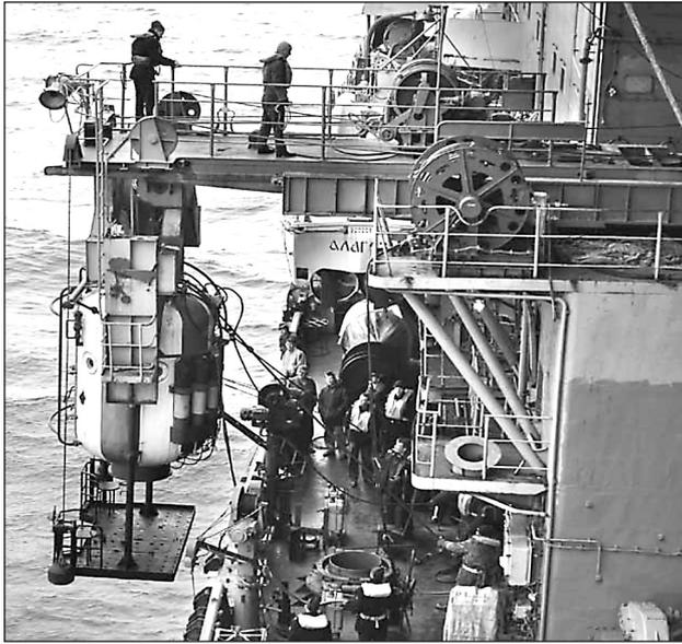
Рис. 7. Подъём водолазного колокола на спасательном судне «Алагеэз» пр. 537
