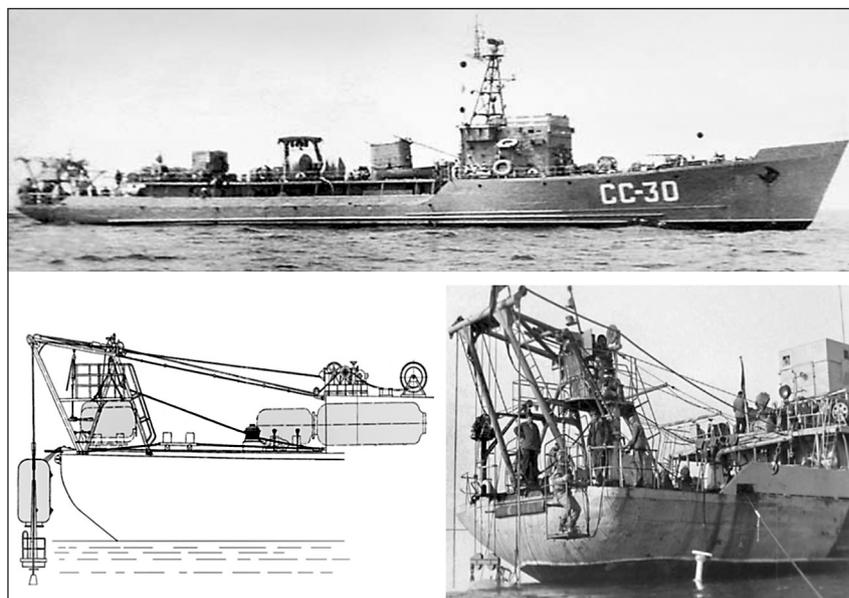
Рис. 6. Кормовое расположение глубоководного водолазного комплекса на спасательном судне СС-30 пр. 532
