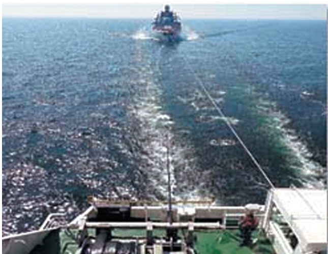
Рис. 4. Испытания УПГ по передаче жидких грузов кильватерным способом на этапе ЗХИ
