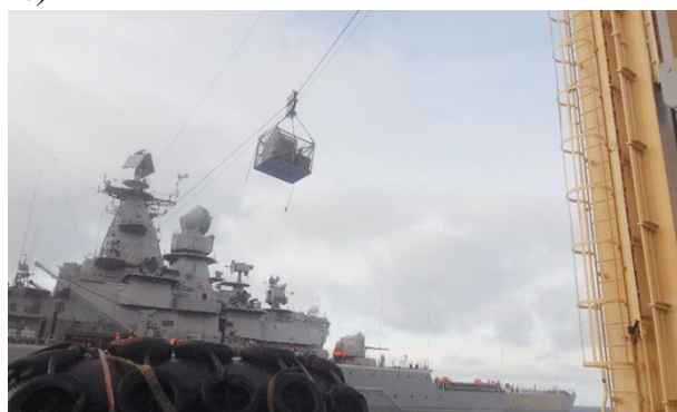
Рис. 11. Проверка работоспособности УПГ при передаче жидких грузов (а) и сухих грузов (б) на ТАРКР «Петр Великий»
