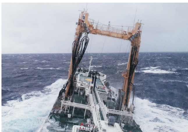
Рис. 10. Мореходные испытания танкера пр. 23130
