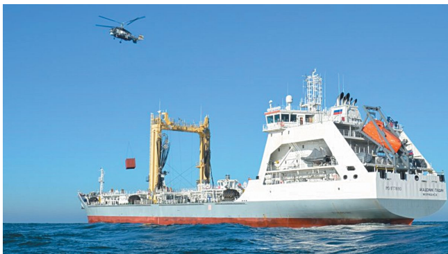
Рис. 5. Испытания устройства передачи сухих грузов вертолетным способом на этапе ЗХИ
