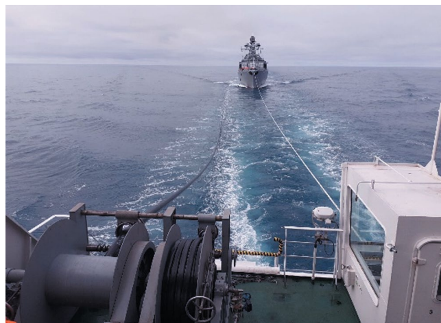
Рис. 7. Испытания УПГ по одновременной передаче жидких грузов кильватерным способом на ходу на БПК пр. 1155
