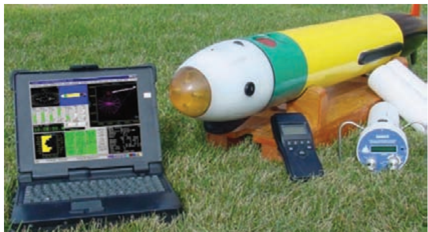
Рис. 6 Технические средства, входящие в состав переносного комплекса АНПА REMUS
