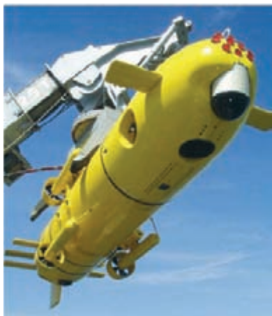
Рис. 3 Автономный противоминный НПА «Redermor» ВМС Франции
