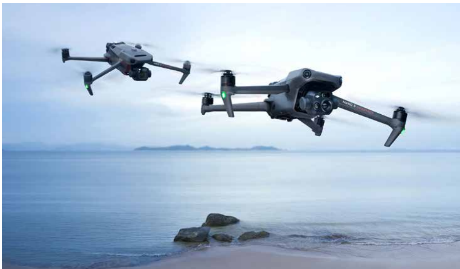
► Использование для разведки малого БЛА Mavic 3T с тепловизионной камерой.
