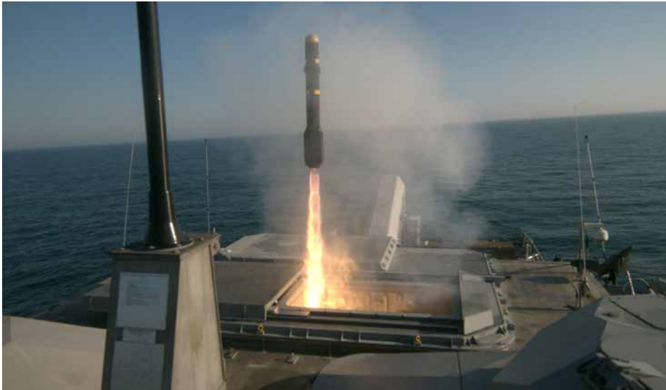
► Пуск управляемой ракеты AGM-114L Hellfire из пусковой установки ракетного модуля SSMM с борта «литторального боевого корабля» (LCS). Фото: U.S. Navy
