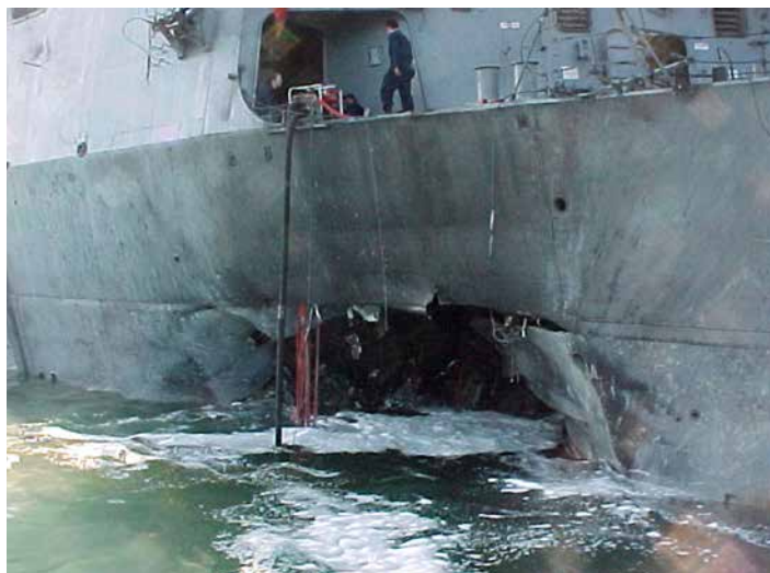
► Пробойна, полученная американским эсминцем «Коул» от взрывающегося катера в порту Адена. Фото: cdn01.dailycaller.com
