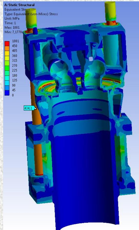
Метод моделирования цилиндрического комплекта при одновременном воздействии температурных, монтажных и рабочих напряжений.
