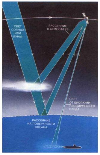
морских организмов *(справа)*. Кроме того, свет, рассеянный от лазерного импульса или от естественных источников, образует сильный «фон», из которого оптическая система обнаружения подводных лодок, размещаемая в космосе, должна выделить полезный сигнал.
