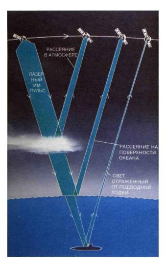
ПОГЛОЩЕНИЕ И РАССЕЯНИЕ СВЕТА атмосферой и в особенности океаном существенно уменьшает величину оптического сигнала, в качестве которого может использоваться либо отраженный от лодки лазерный импульс (слева), либо вынужденная люминесценция
