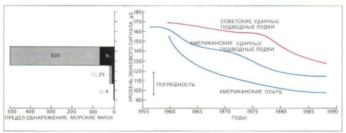
УРОВЕНЬ ШУМА, создаваемого подводной лодкой, определяет величину максимального расстояния, на котором она может быть обнаружена (слева) с помощью гидрофонов (подводных микрофонов) на глубинах свыше 1200м (серый) и менее 300 м (черный). Как советские
