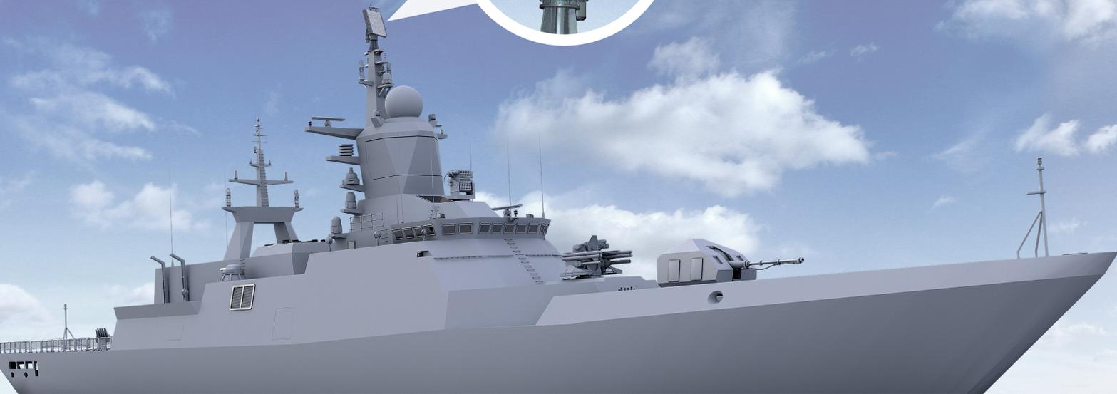
Корабельная трехкоординатная одноканальная радиолокационная станция «Фрегат-МАЭ-4к» предназначена для обнаружения воздушных и надводных целей и обеспечения целеуказания огневым средствам. РЛС «Фрегат-МАЭ-4к» разработана и производится ФГУП «ГМЗ «Салют».
