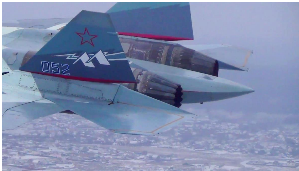
Самолет Су-57 с двигателем АЛ-41Ф-1
